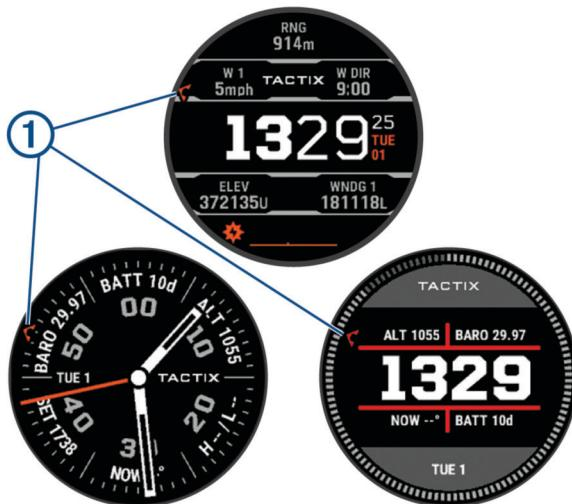
**1** Стрелка всемирного координированного времени (UTC). Отображается при выборе циферблата на 24 деления.
